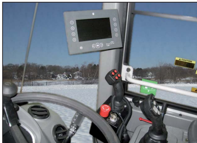
INSTALLATION TYPE SUGGÉRÉE DANS LE CHARGEUR
